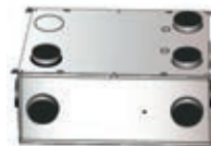
Montaje en techo solo con entálpico (no hace falta toma de condensados ni inclinación). Pedir un extra soporte de montaje techo (KEO350/500MOBDB) y un registro mantenimiento (KEOREGT)
