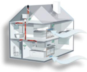
Suele haber un sensor de  $\text{CO}_2$  en las estancias por las que se realiza la admisión de aire. Sólo cuando se encuentren una o más personas (producción de  $\text{CO}_2$ ), el aire de la sala se irá contaminando, entonces el sistema empezará a reaccionar y a ajustar el caudal de aire fresco según se necesite.
