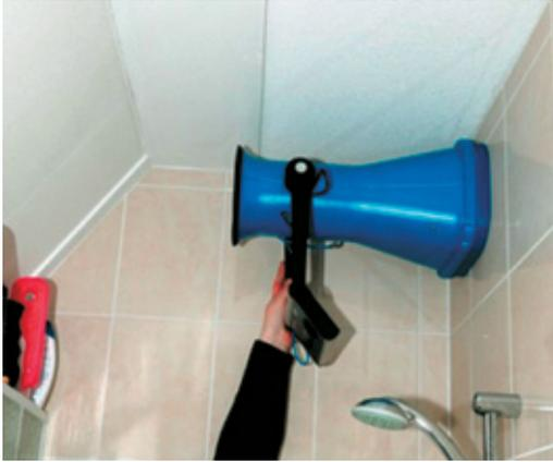
**Foto 6.1.** Equipo de medición de caudal con pérdida de presión compensada con un alcance, por ejemplo, entre 15 y 225 m<sup>3</sup>/h para aplicaciones en viviendas (UNE12599).
