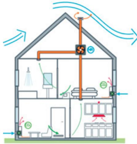
Figura 3.6. Sistema tipo D con admisión descentralizada.
