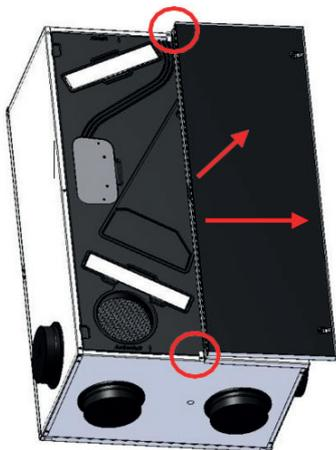
Antes de sacar las conexiones pre-cortadas, se debe retirar la parte delantera del equipo, quitar los dos tornillos de fijación y levantar ligeramente la parte delantera y empujarla hacia un lado.
