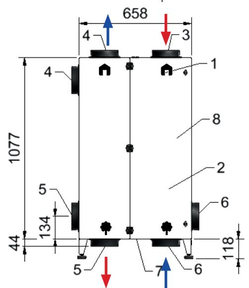
Las conexiones de entrada y salida de aire exterior y la admisión de aire, pueden realizarse según las circunstancias, detrás, lateralmente o en la parte inferior, rompiendo las conexiones metálicas precortadas.
