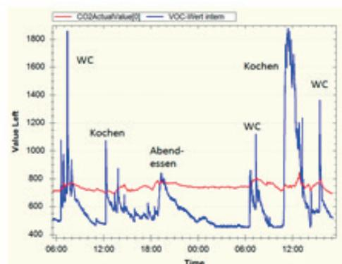
Mide los compuestos orgánicos volátiles (VOC) que, p. ej., se emiten a través de la respiración, los muebles, las alfombras, pinturas, impresoras. El valor de la calidad del aire en equivalentes de CO<sub>2</sub> se determina mediante un algoritmo a partir de una señal de la suma de todos los componentes contenidos en el gas mezclado. A continuación, dependiendo del ajuste de sensibilidad, se aumenta el caudal de aire de impulsión y se controla la renovación de aire según sea necesario.
